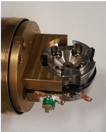
Blick in die offene Hälfte einer Diamantstempelzelle. Darunter ist ein Trimmer-Kondensator (grün) befestigt. Foto: Thomas Meier.
